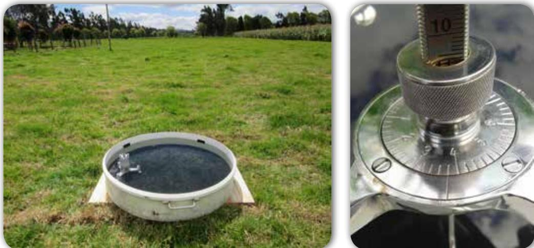
**Figura 22.** Tanque evaporímetro y tornillo micrométrico para lectura de lámina agua evaporada.
