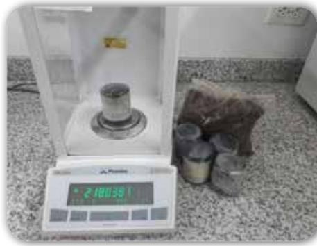
**Figura 26.** Método gravimétrico para determinar la humedad del suelo.
