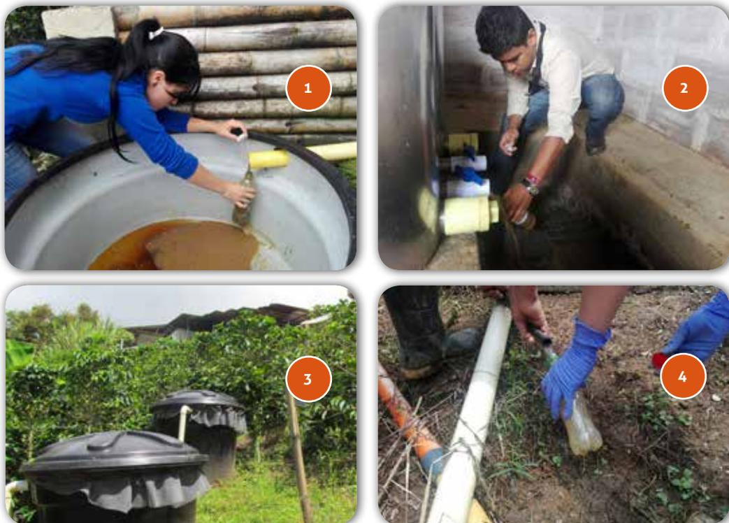
**Figura 37.** Toma de muestras para la determinación de la HH Gris.
