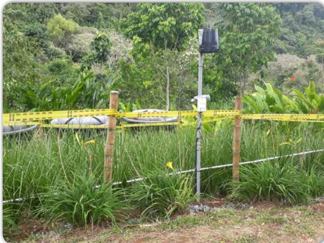
**Figura 14.** Pluviómetro de registro automático y datalogger en zona cafetera.
