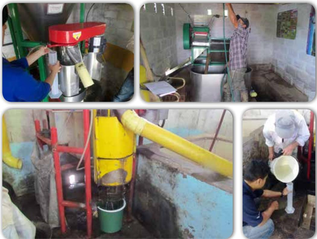
**Figura 36.** Procedimiento para medición de caudal.
