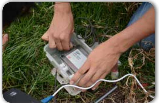
**Figura 27.** Sensores de humedad instalados en los diferentes perfiles del suelo.
