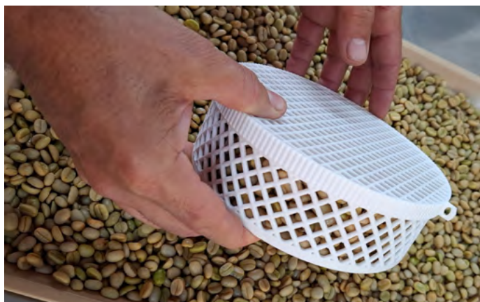
Figura 70. Implemento para el monitoreo de la humedad del café durante el secado mecánico Gravimet SM2.
