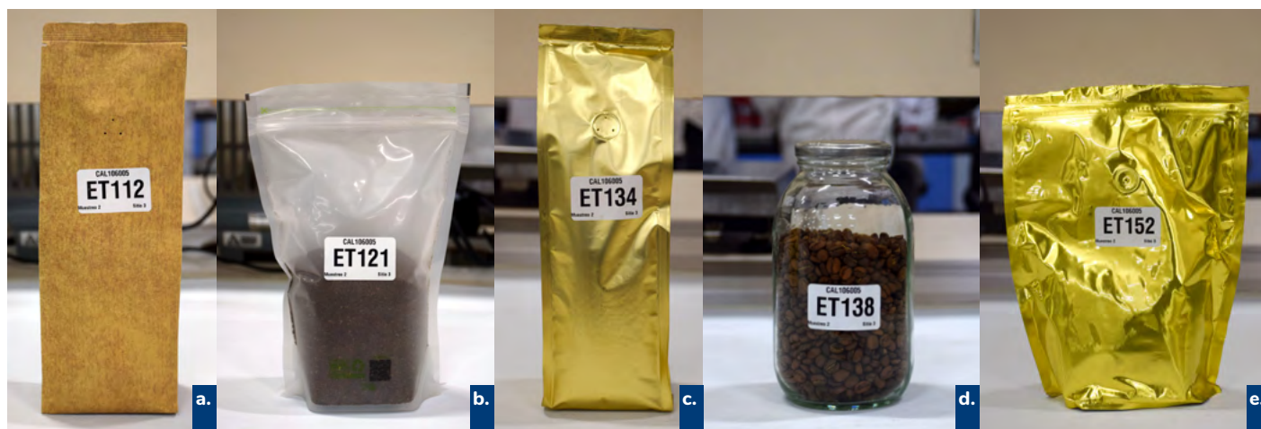
Figura 16. Representación esquemática de los empaques: a. papel Kraft (PK), b. polietileno trilaminado de alta densidad EVOH reciclable (PETHD), c. polietileno con aluminio (ALP), d. vidrio transparente (VT) y e. polietileno baja densidad (PELD).
