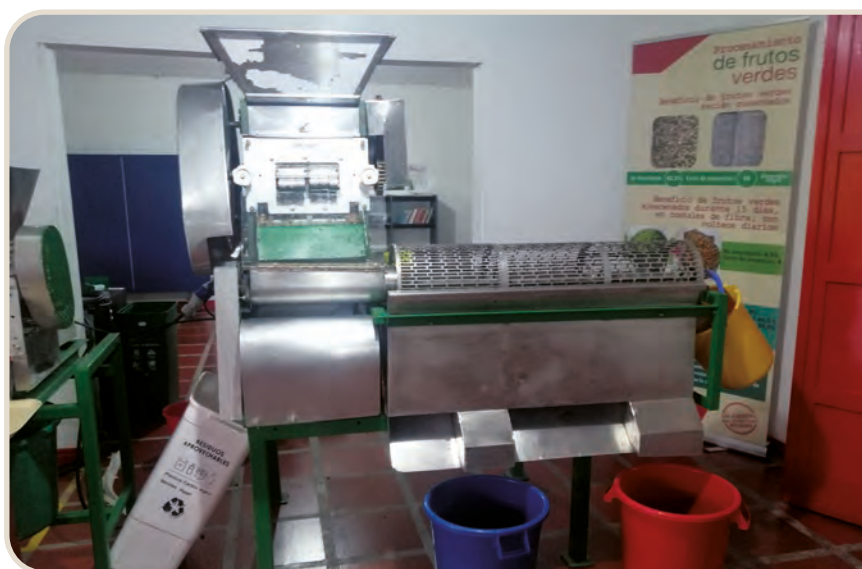
Figura 60. a. Pechero en aluminio; b. Máquina despulpadora Cenicafé con cuatro pecheros para 2.400 kg h -1 .
