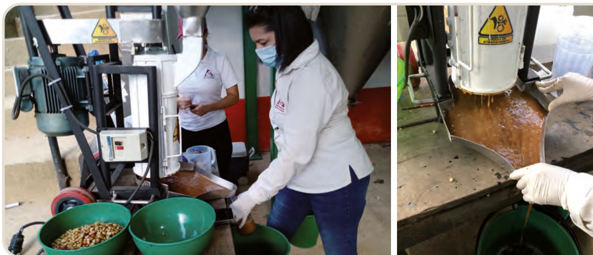
Figura 66. Equipo Desmucilagador-Lavador Experimental para toma de muestra de mucílago y semilla café lavado.
