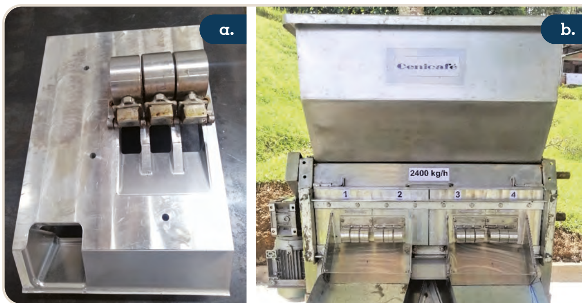
Figura 60. a. Pechero en aluminio; b. Máquina despulpadora Cenicafé con cuatro pecheros para 2.400 kg h -1 .
