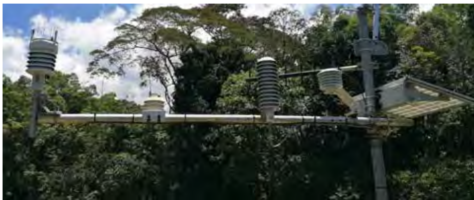
Figura 99. Estación de prueba del transmisor Vaisala WXT536.
