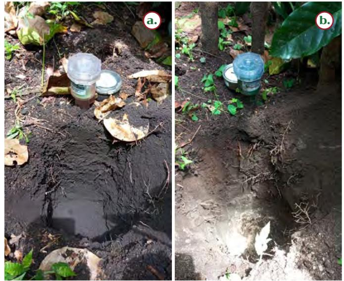
**Figura 115.** Ubicación de los dos tensiómetros en las parcelas experimentales. **a.** Tensiómetro ubicado en la parcela 3. **b.** Tensiómetro ubicado en la parcela 1.
