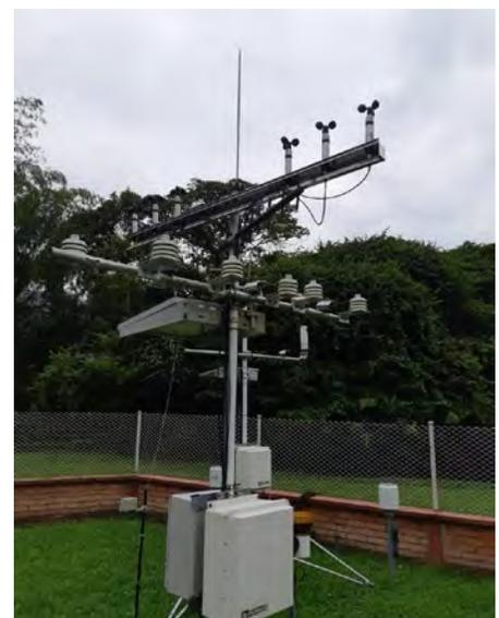
Figura 120. Estación climática automática.
