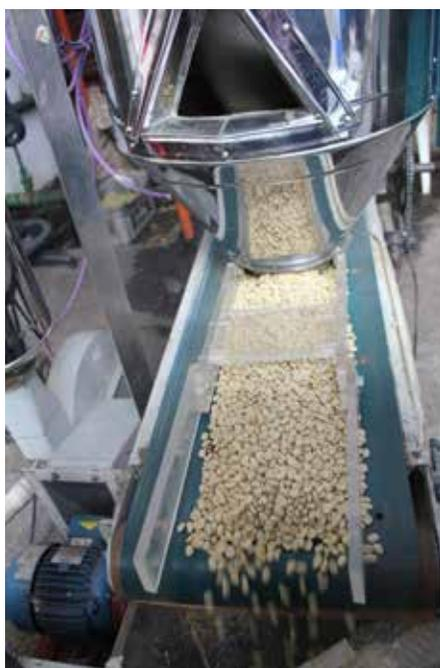
**Figura 68.** Secador intermitente de flujos concurrentes (IFC64).
