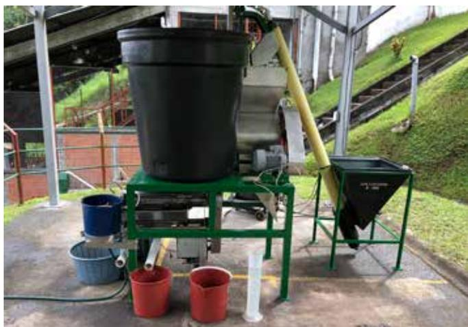
**Figura 67.** Equipo Ecomill LH300 para el lavado del café.
