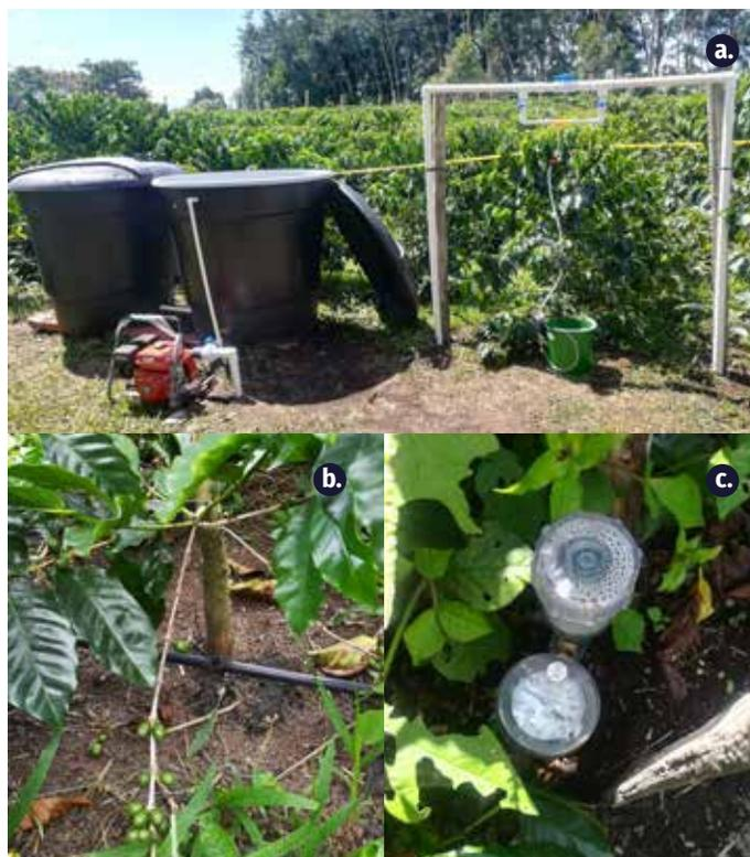
**Figura 98.** Sistema de riego establecido. **a.** Tanques de almacenamiento, motobomba e inyector tipo venturi, **b.** Plantas de café con gotero autocompensado y **c.** Tensiómetro de 25 cm.
