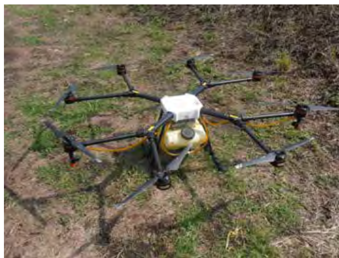
Figura 7. Dron de uso agrícola en la aspersión de pesticidas.
