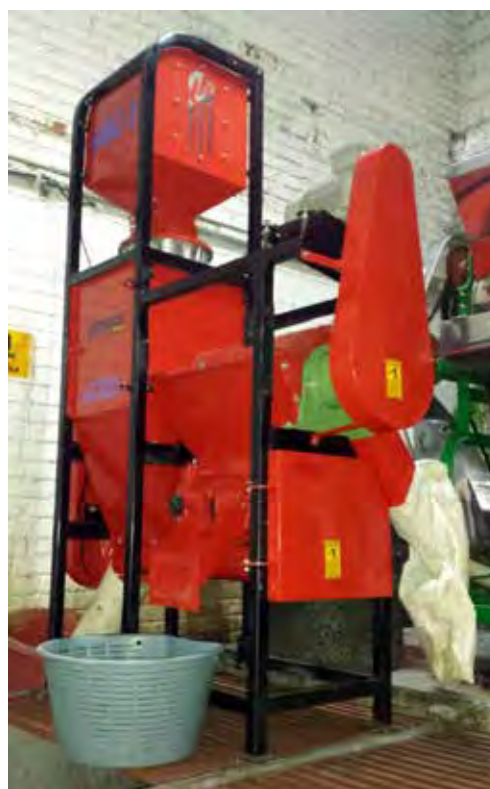
Figura 66. Sistema de despulpado de café con separación de frutos verdes.
