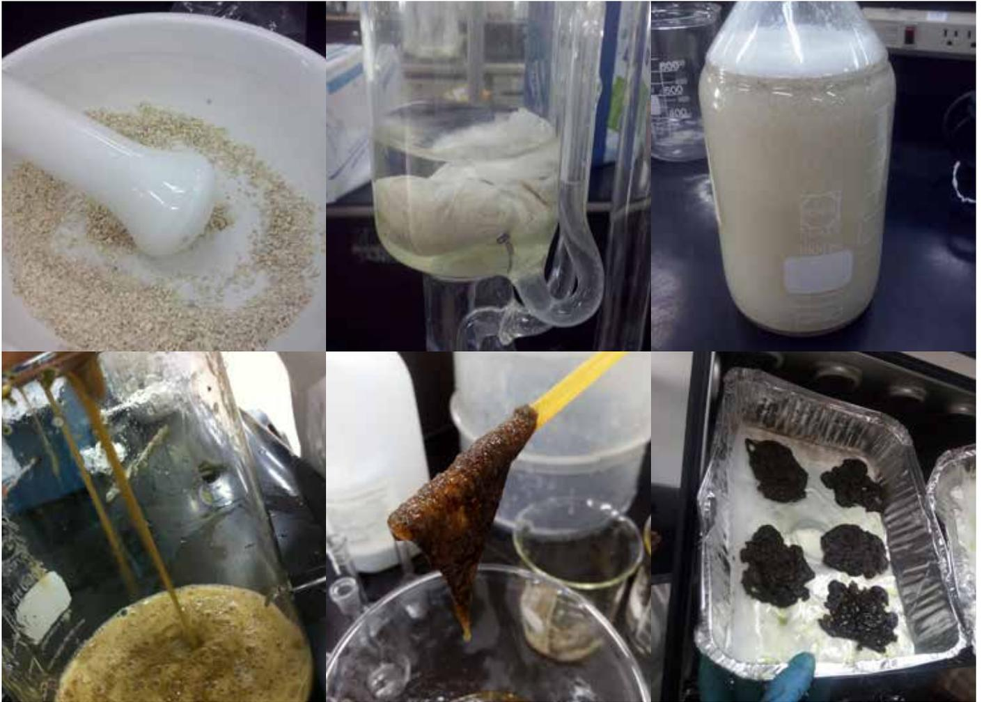
**Figura 54.** Extracción del compuesto coagulante en las diferentes plantas.
