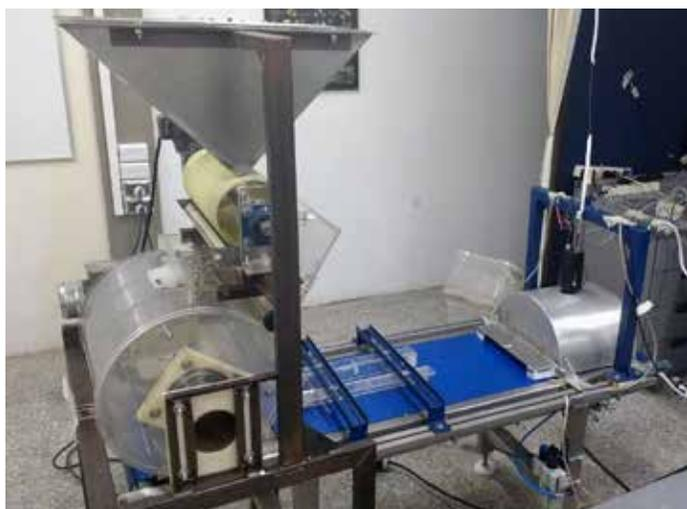
**Figura 46.** Máquina para la clasificación de café lavado.
