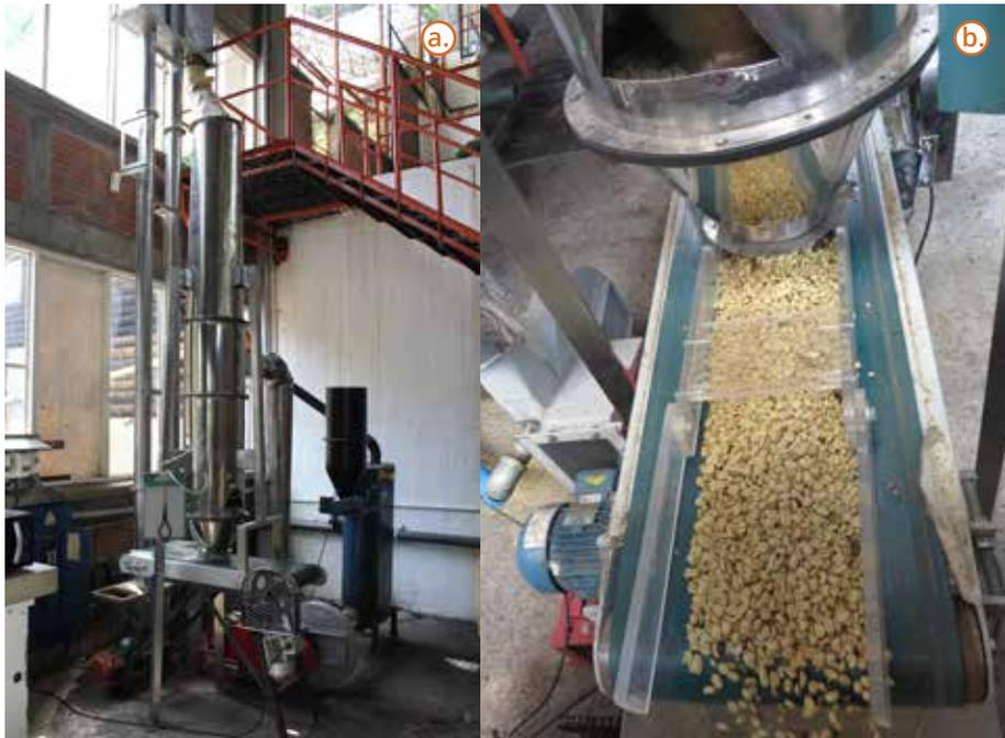
**Figura 49.** Secador intermitente de flujos concurrentes diseñado para café pergamino - IFC 62 (a), café pergamino transportado en la banda reguladora de flujo de café a través del secador (b).
