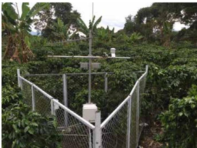
**Figura 84.** Microestaciones meteorológicas. Estación en el departamento del Huila
