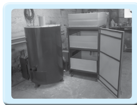
Figura 88. Secador para café de tres cámaras, diseñado para utilizar alcohol carburante como combustible.
