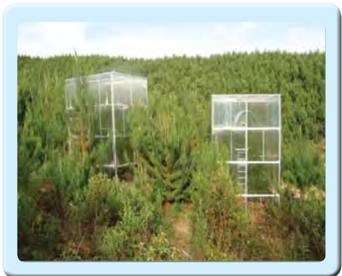
Figura 78. Sistema de medición de intercambio gaseoso en plantas completas y hojas individuales.
