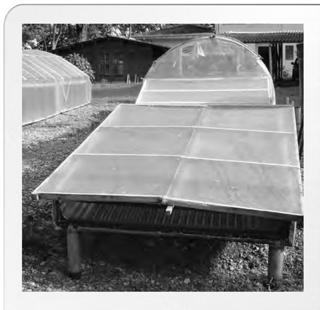
**Figura 33.** Secador solar tipo túnel con colector solar plano
