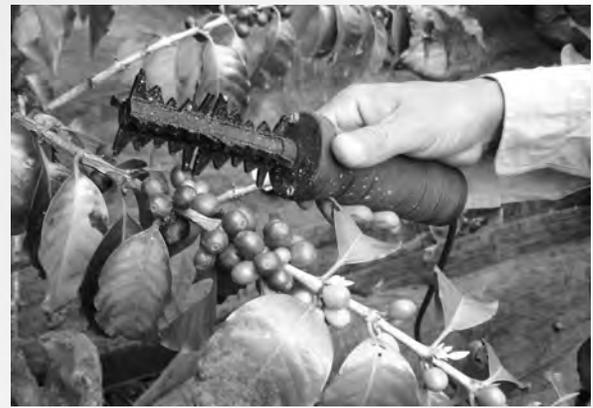
**Figura 30.** Equipo portátil para cosecha de café Alfa-Cenicafé, con impactador largo
