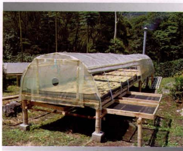
Figura 23. Secador solar para café híbrido (solar y con adición de energía térmica) SAMBA-20H desarrollado en Cenicafe.
