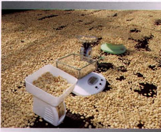
Figura 22. Balanzas utilizadas en el método GRAVIMET desarrollado en Cenicafe para monitorear la humedad del café secado al sol
