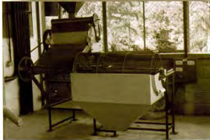
Figura 42. Descascaradora de macadamia. Módulo DESMACI.
