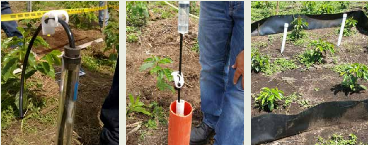
Figura 13. Instalación de los lisímetros (cápsulas de succión), a 45 cm de profundidad (dos por parcela experimental). Una vez instalados, se protegió la parte emergente con tubería PVC-S de 2" con su respectivo tapón.
