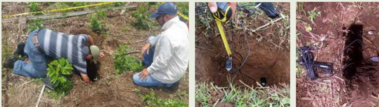
Figura 12. Instalación de sensores de humedad a 15 y 45 cm de profundidad.
