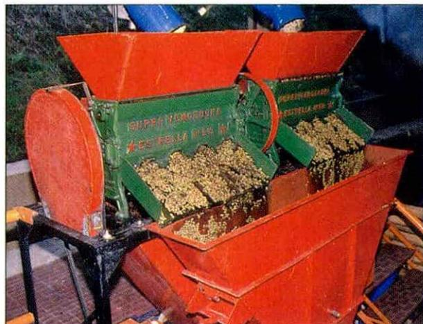
**Figura 15.** Despulpadoras de eje horizontal, operadas sin agua.
