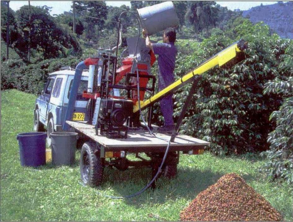
Figura 68. Módulo BECOLSUB 600 móvil, remolcado por un vehículo campero.
