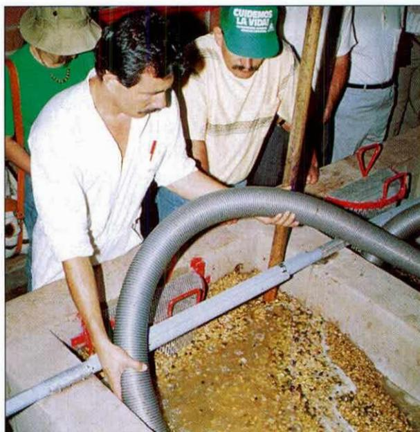
**Figura 27.** Lavado del café durante su transporte con motobomba, utilizando cuatro enjuagues.
