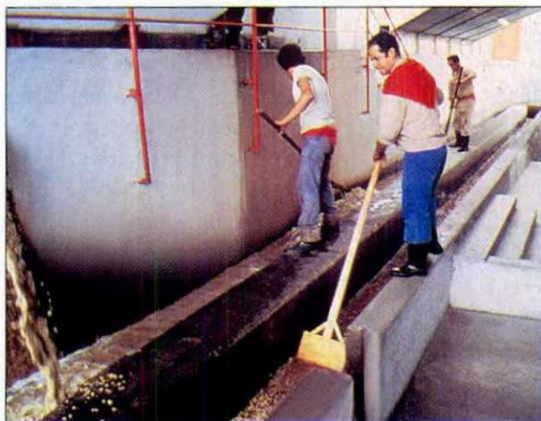
**Figura 25.** Lavado del café con mucilago fermentado en canales de correteo, mediante agitación manual.
