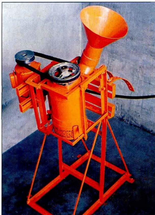
**Figura 36.** Desmucilagador por agitación con rotor tipo CENICAFÉ-B-I.
