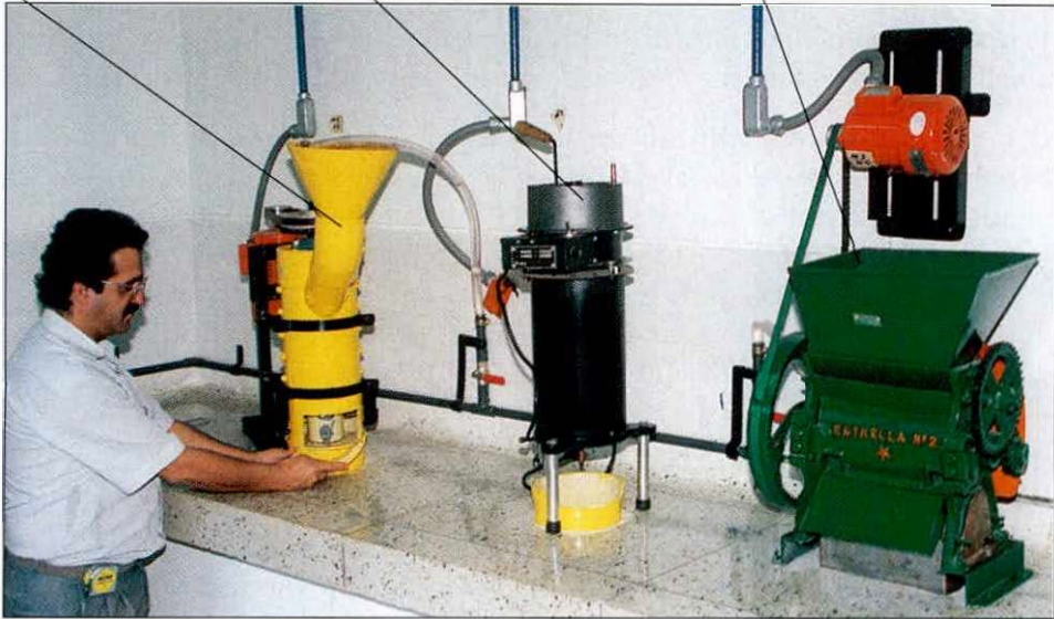
Figura 119. Desmucilaginator, Determinador de Humedad MH-2, Despulpadora. (Elementos del método CERPER modificado, Anserma, Caldas).
