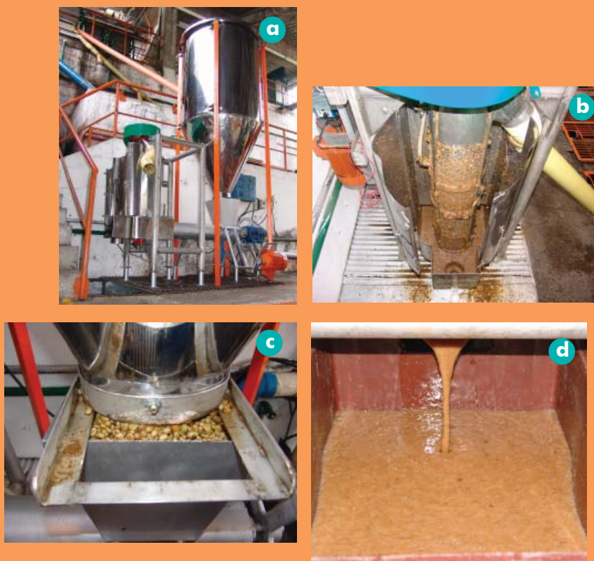
Figura 9. Tecnología para lavado del café en proceso con fermentación natural y con aplicación de enzimas pectinolíticas. Vista general del equipo (a), detalle de la descarga del tanque de fermentación (b), lavador mecánico (c) y mieles generadas en el lavado (d).
