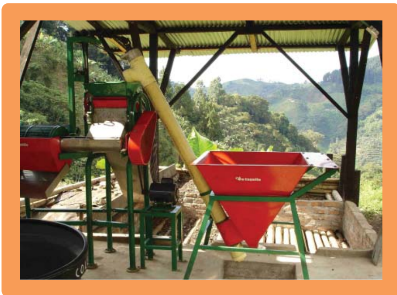
Figura 6. Separador hidráulico de tolva y tornillo sinfín desarrollado en Cenicafé por Oliveros y Col. (2007)
