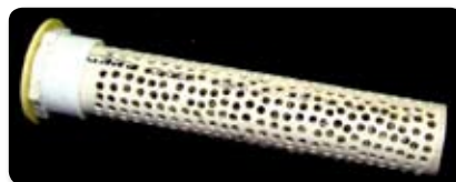
Figura 15. Dispositivo de salida de las aguas mieles de la trampa de pulpas.
