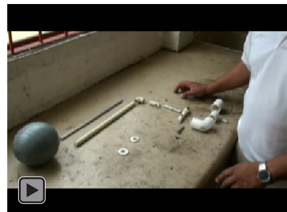
Materiales para la construcción de la válvula flotador
