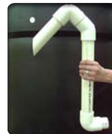
Figura 20. Aspecto del dispositivo de salida de los reactores hidrolíticos.
