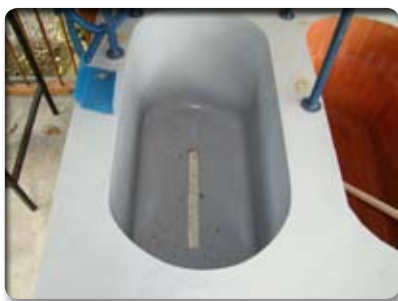
Figura 10. Tanques tina para el lavado del café.
