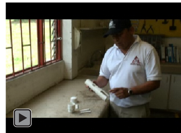
Fabricación de la válvula para el tanque tina
