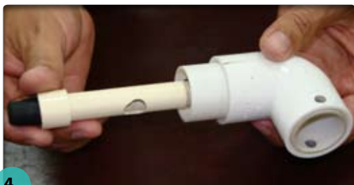
Figura 29. Montaje de la válvula flotador de la recámara dosificadora.
