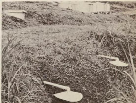
Detalle de los colectores de las aguas de los lisímetros.
