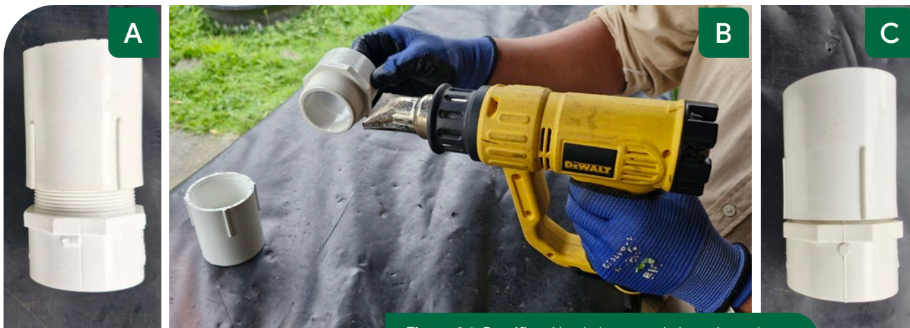
Figura 24. Rectificación de la rosca de los adaptadores de PVC. A. Acople inicial incompleto. B. Calentamiento del roscado del adaptador macho. C. Acople final completo.
