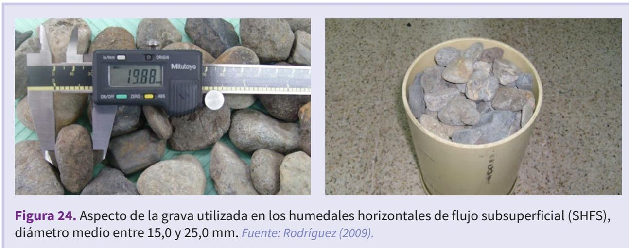
**Figura 24.** Aspecto de la grava utilizada en los humedales horizontales de flujo subsuperficial (SHFS), diámetro medio entre 15,0 y 25,0 mm. *Fuente: Rodríguez (2009).*
