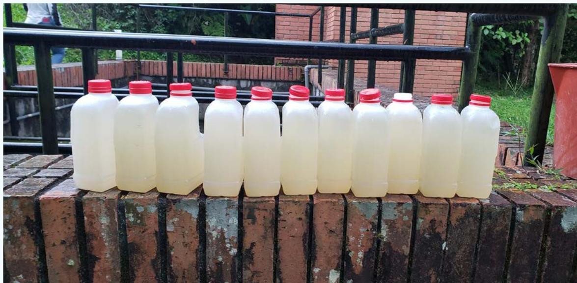
**Figura 33.** Aspecto de las submuestras de agua residual tomadas durante el proceso de muestreo de los sistemas sépticos.
