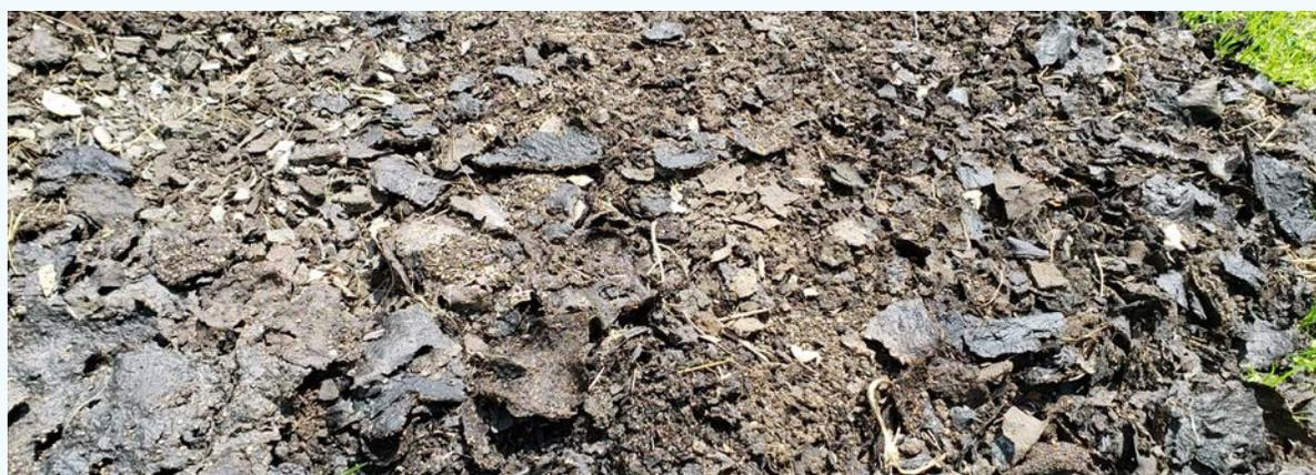
**Figura 40.** Aspecto de los lodos resultantes de los lechos de secado.
