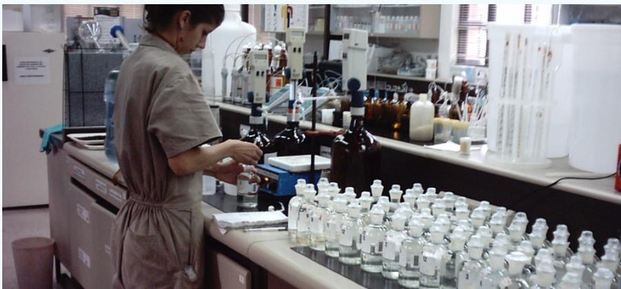
**Figura 2.** Determinación de DBO<sub>5</sub>.
