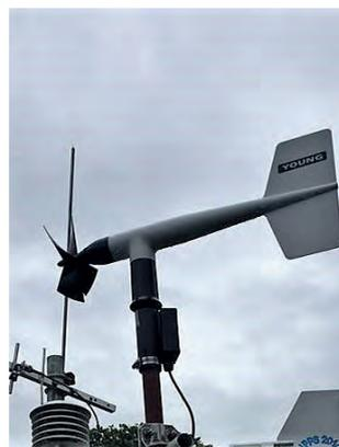
**Figura 11.** Sensor de velocidad y dirección del viento.
