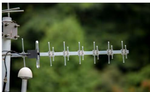
Figura 16. Antena estaciones meteorológicas.
