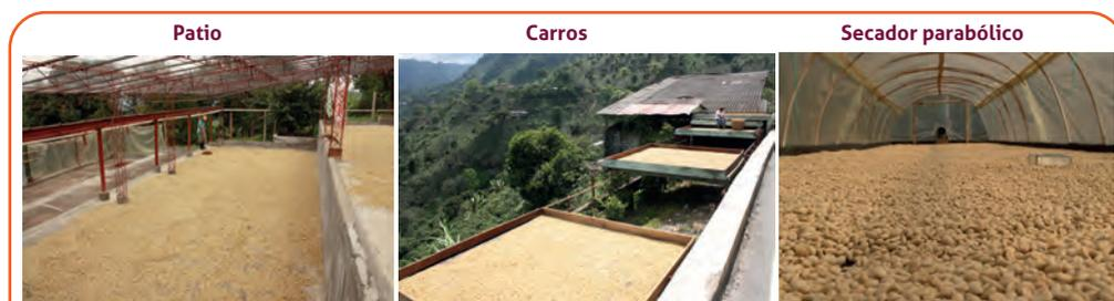
*Figura 9. Estructuras empleadas para el secado solar.*
