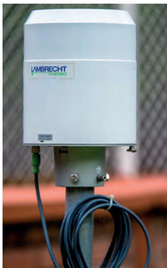
**Figura 3.** Pluviómetro gravimétrico.
