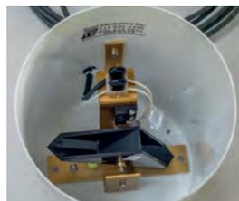
**Figura 4.** Pluviómetro de balancín.
