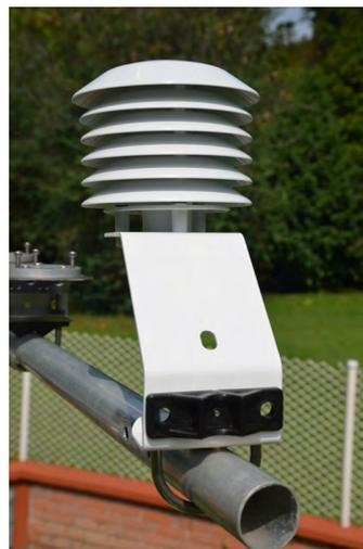
*Figura 6. Protector de radiación del sensor.*
