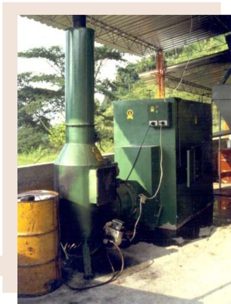
El aire puede calentarse con estufas y quemadores, entre otros, que funcionan con ACPM, carbón mineral y energía eléctrica. No use aceite quemado como combustible.
