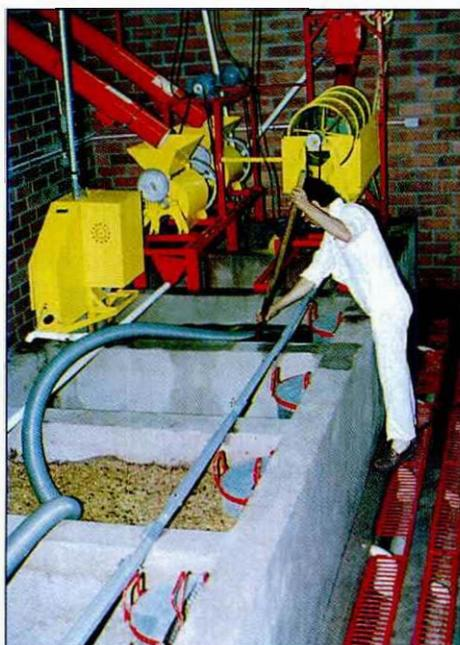
**Figura 52.** Sistema de zaranda clasificadora, transportador por el sistema cable - disco, 7 tanques de fermentación y lavado mediante motobomba utilizada para el transporte del café. Cenicafé, Paraguaicito, Quindío 1993-1995.
