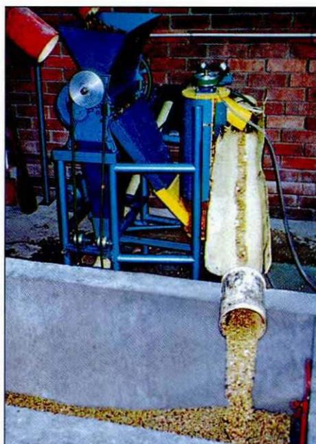
**Figura 53.** Simplificación del sistema de lavado, limpiando y clasificando del café mediante el módulo BECOLSUB, en una cuarta parte del espacio anterior. Cenicafé, Paraguaicito, Quindío 1996.
