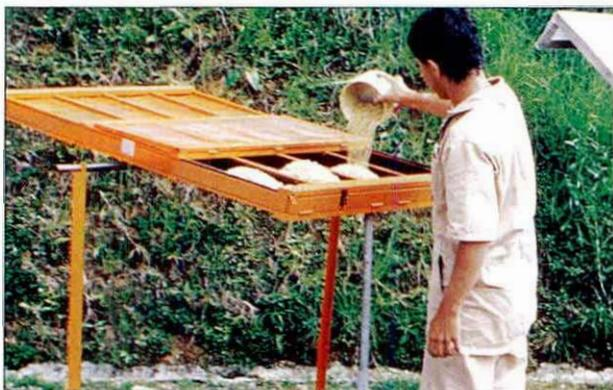
**Figura 89.** Secador solar rotatorio para café.
