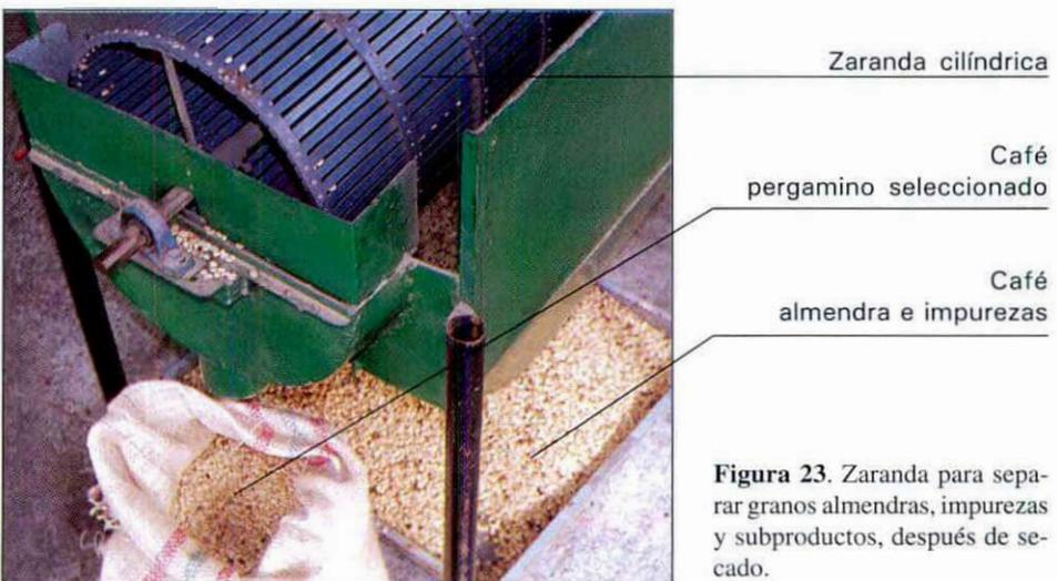
**Figura 23.** Zaranda para separar granos almendras, impurezas y subproductos, después de secado.
