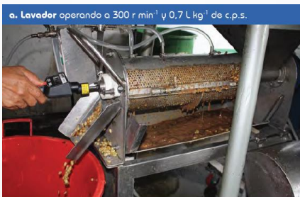
a. Lavador operando a 300 r min -1 y 0,7 L kg -1 de c.p.s.
