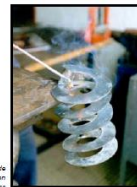
Figura 7. Unión de los discos con soldadura eléctrica
