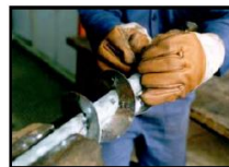
Figura 9. Discos estrados cuidadosamente sobre el eje
