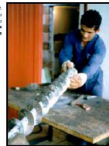
Figura 9. Discos estrados cuidadosamente sobre el eje
