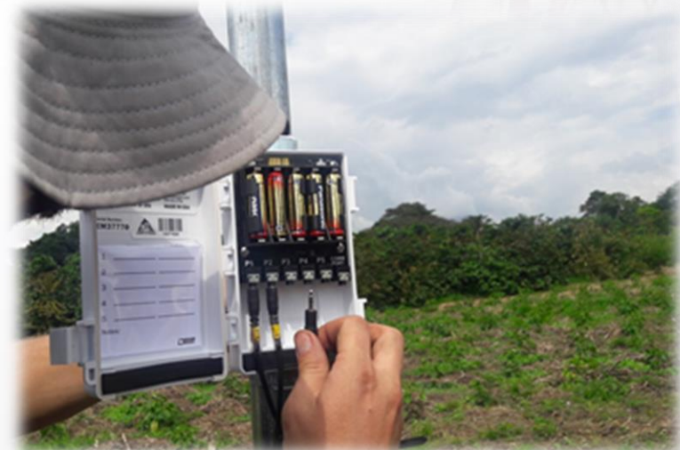
Datalogger 5 canales. Marca Decagon
