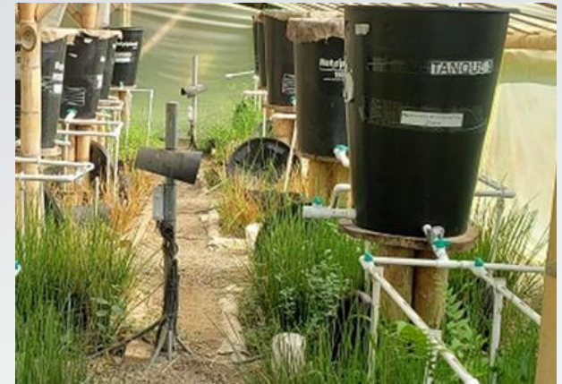
Sistema de riego de los filtros verdes, con el agua residual a evaluar
