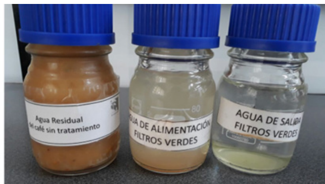
Figura 1. Aspecto del agua residual a la salida del beneficiadero, del pretratamiento y del filtro verde.
