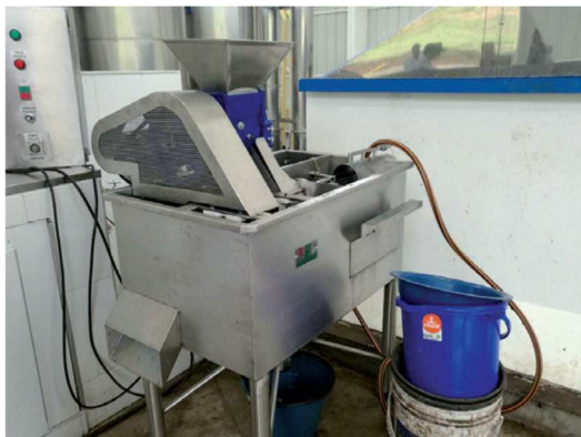
Figura 4. Equipo fabricado por la industria nacional que permite despulpar y lavar el café en 2 minutos
