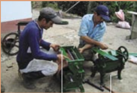
Platinas alimentadoras Chasis
