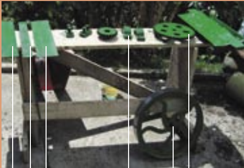
Platinas alimentadoras Cuñeras o chumaceras Volante Piñones
