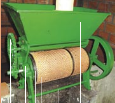
Chasis Tolva Volante Camisa o rallo Cilindro Cuñeras o chumaceras Piñones
