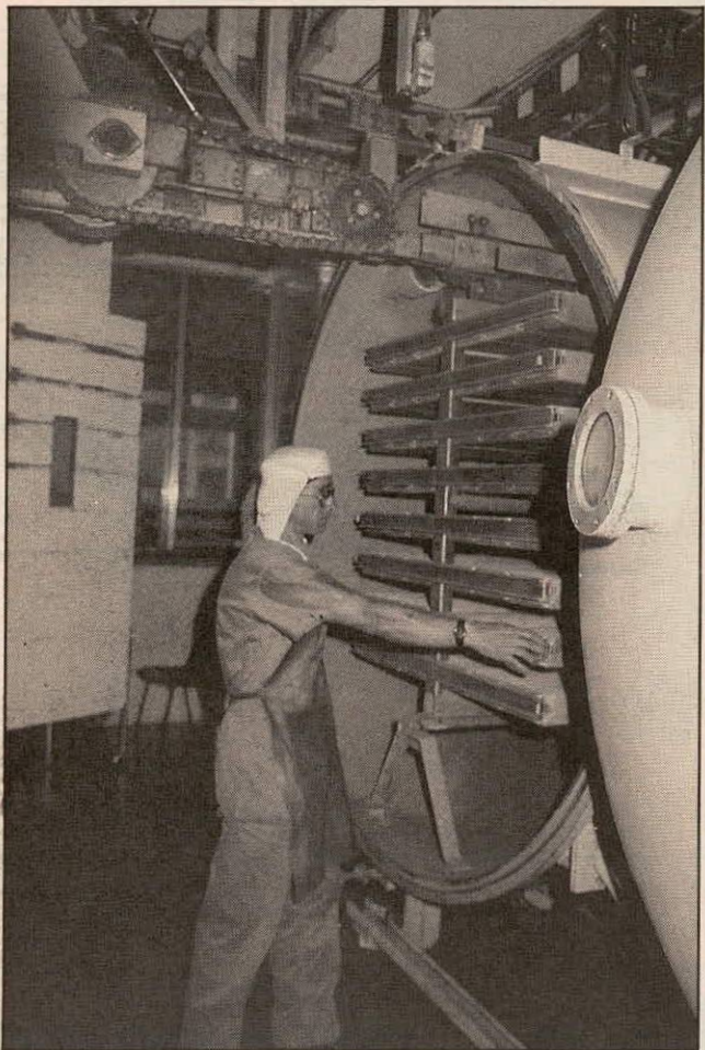
En la liofilización, hecha en túneles o cámaras especiales, se elimina el agua incorporada en el extracto.
